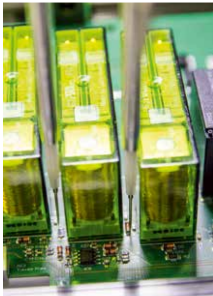
Mit dem Flying-Probe-Test werden bei Ihlemann auch Baugruppen mit engen Bauteilabständen von unter 0,3 mm geprüft, weil sich die Testnadeln sehr präzise navigieren lassen.
