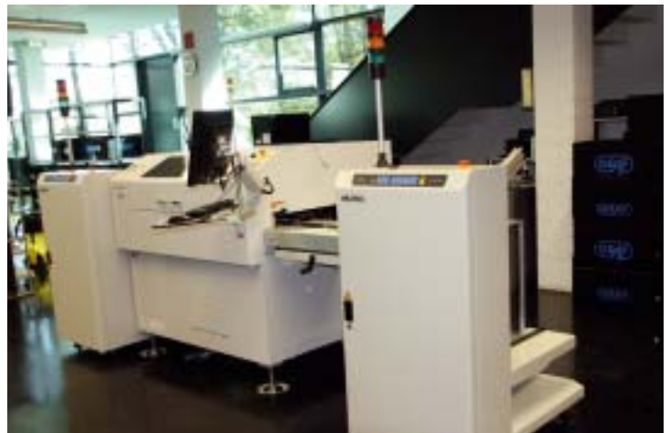
Zwei völlig identische Flying Probe Testsysteme inklusive Be- und Entladestationen stehen als Insellösung in der Elektronikproduktion
