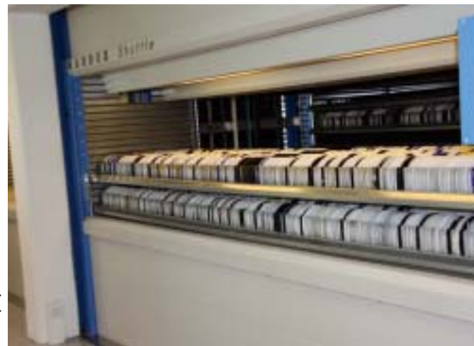
Zwei vollautomatisierte Hochregallager sorgen dafür, dass stets die benötigten Bauteile zur rechten Zeit Verfügung stehen
