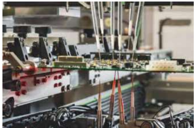
Mit dem doppelseitigen Konzept der Flying Probe Systeme spart es Testzeit und Rüstaufwand
